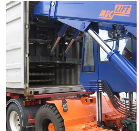
"Мы используем два погрузчика Meclift ML1612R для загрузки и разгрузки рулона стали в контейнерах в нашем порту. Эти машины имеют уникальную конструкцию. Благодаря их компактности и отличной способности подъема грузов на большую высоту мы можем использовать их и в других работах. Иногда мы задаемся вопросом, как некоторые из этих работ могли бы быть выполнены без погрузчиков Meclift."
