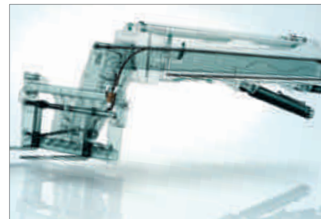
Шланги проложены внутри стрелы
